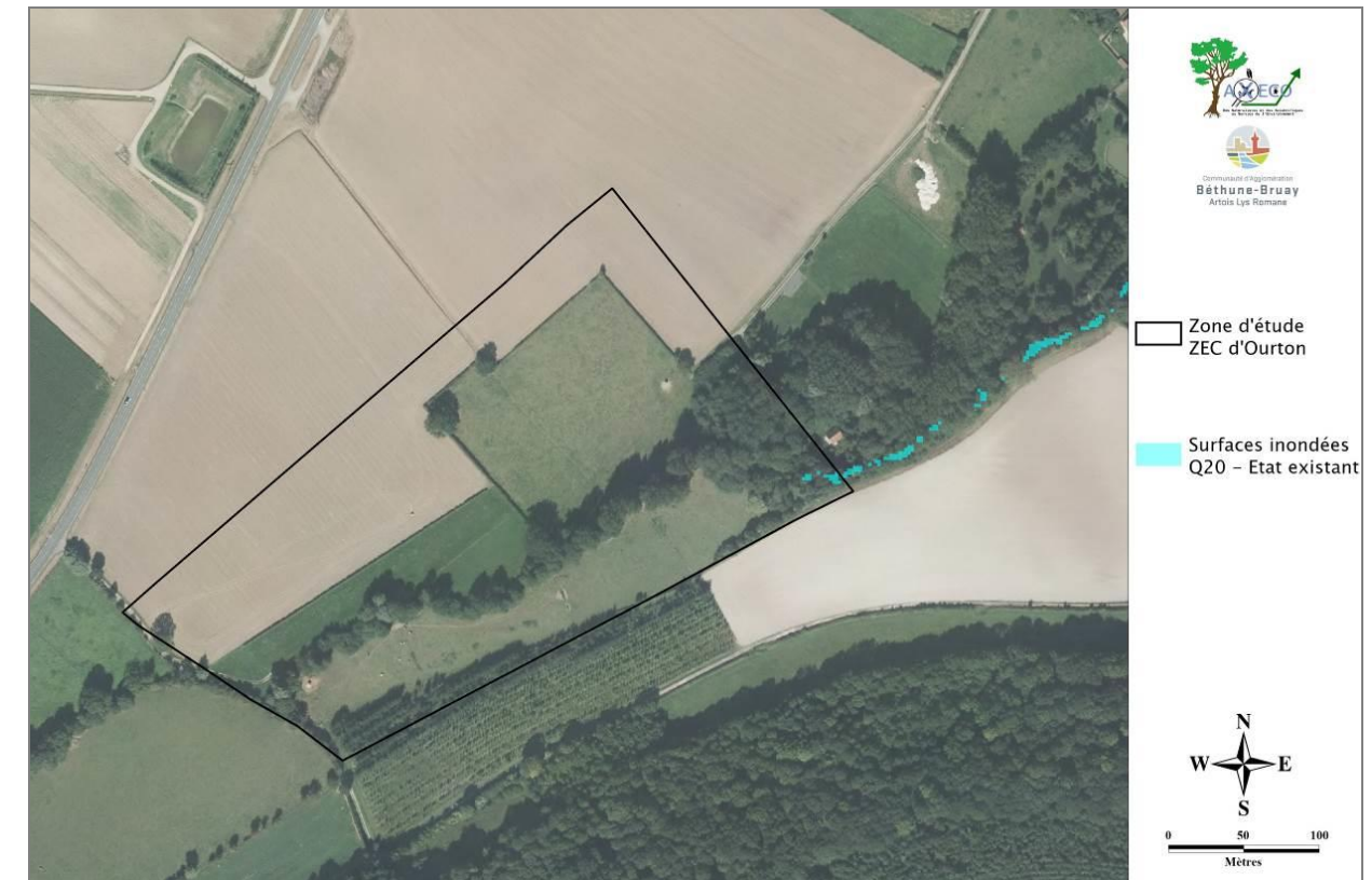
Figure 27 : Surfaces inondées actuellement pour la crue de projet à Ourton
