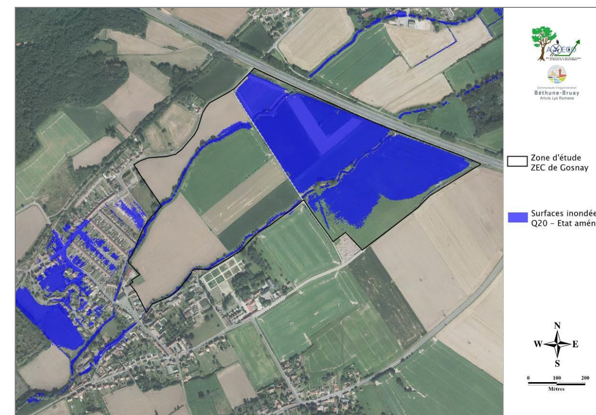
Figure 32 : Surfaces inondées après aménagement pour la crue de projet à la Comté
